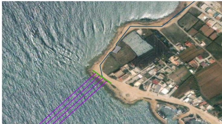
Figura 2.3 Vista dell'approdo e della giunzione tra i cavidotti marini (viola) e i cavidotti di terrestri (blu)
