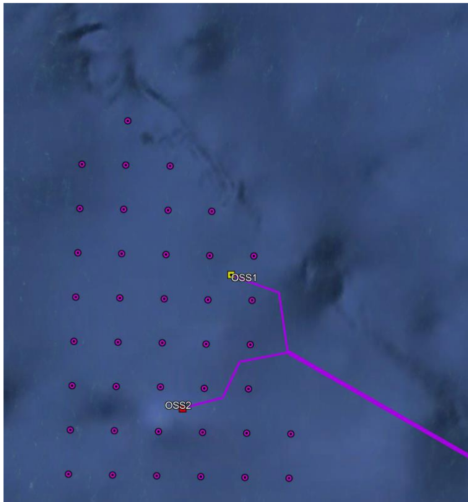
Figura 2.2: Vista delle posizioni delle stazioni di trasformazione OSS1 e OSS2
